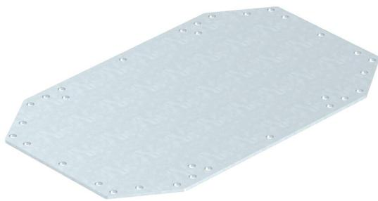
Esta placa de montaje permite la fijación flexible de componentes externos en la caja de empalme. Consta de una chapa de acero galvanizado en banda con un espesor de material de 2 mm.
