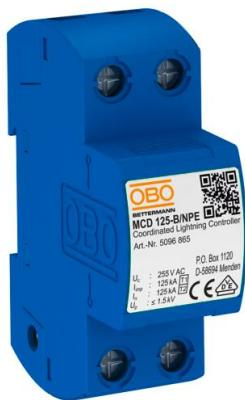
Descargador combinado tipo 1+2, N-PE para sistemas de redes TN-S y TT.MCD 125-B/NPE: Vía de chispas coordinada N-PE tipo 1+2 según EN 61643-11. Para la conexión de 0 a 2 (LPZ) según el concepto de zonas de protección contra rayos de la norma IEC 62305 o VDE 0185-305.
