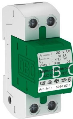
Descargador de corrientes de rayo tipo 1 según EN 61643-11 para la transición entre zonas 0 y 1 (LPZ) según el concepto de protección contra descargas atmosféricas definido en la norma IEC 61312-1 o VDE 0185-305 (IEC 62305)
