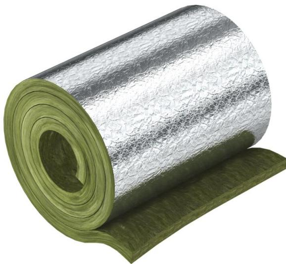
Esteras de lana mineral con recubrimiento de aluminio para aislamientos en tramos para tubos de cobre y acero. Fijación del aislamiento en tramos con alambre bobina y aseguramiento de las juntas con cinta adhesiva de aluminio.
