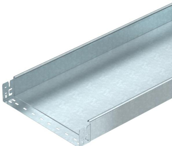
Bandeja portacables sin perforar con sistema de fijación rápida integrado. La longitud útil de la bandeja portacables es 3.000 mm. La conexión equipotencial continua queda asegurada sin componentes adicionales.
