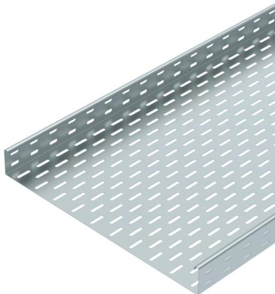
MKS 60 = sistema de bandejas portacables para cargas medias de ala 60 mm. Testada para la instalación por encima de techos suspendidos de protección contra incendios (tipo: GRM 55 100 G, GRM 55 200 G, GRM 55 300 G, GRM 55 400 G, carga de fuego 30 minutos, ejecución y parámetros de montaje según informe pericial de seguridad contra incendio). Aislamiento magnético sin tapa 20 dB, con tapa 50 dB.
