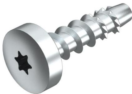
Tomillo de anclaje con cabeza redonda contra el fuego para el montaje directo sin tacos. Propulsión T30, orificio 5 mm. Taco probado según ETAG 001 - parte 3. Clase de resistencia contra el fuego hasta R120 para hormigón y mampostería.
