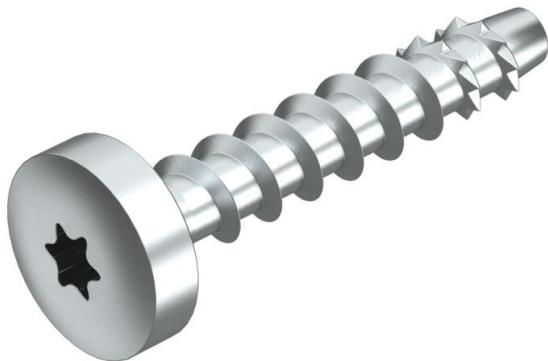
Tomillo de anclaje con cabeza redonda contra el fuego para el montaje directo sin tacos. Propulsión T30, orificio 5 mm. Taco probado según ETAG 001 - parte 3. Clase de resistencia contra el fuego hasta R120 para hormigón y mampostería.
