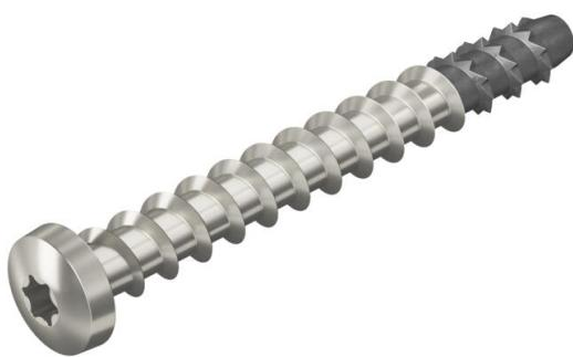
Anclaje de acero inoxidable para el montaje directo sin tacos en hormigón fisurado y no fisurado, y muros. Con cabezal redondo para las fijaciones universales en espacios húmedos y zonas exteriores. Accionamiento Torx T30.
