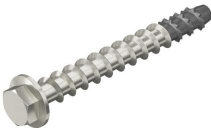
Anclaje de acero inoxidable para el montaje directo sin tacos en hormigón fisurado y no fisurado, y muros. Con accionamiento hexagonal y arandela prensada para soportar grandes cargas. Apropiado para la fijación de perfiles colgantes y escuadras de pared en espacios húmedos y zonas exteriores.
