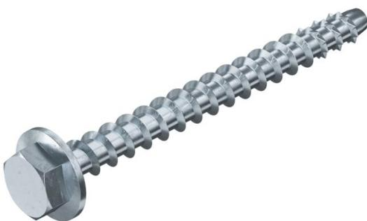
Anclaje para el montaje directo sin tacos de hormigón fisurado y no fisurado, y muros. Con accionamiento hexagonal y arandela prensada para soportar grandes cargas. Apropiado para la fijación de perfiles colgantes y escuadras de pared en espacios húmedos y zonas exteriores.
