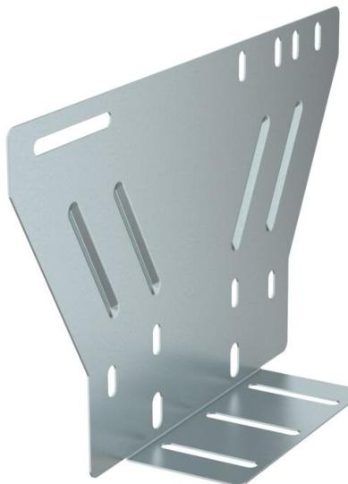
Placa de montaje universal para la fijación de FireBox serie T en la parte trasera de bandejas portacables y bandejas de rejilla, y escaleras de cable con ala máx. de 60 mm. Permite el montaje seguro de los cables de mantenimiento de función, sin que sea necesario doblarlos sobre la barra lateral. Apropiado para todas las FireBox.
