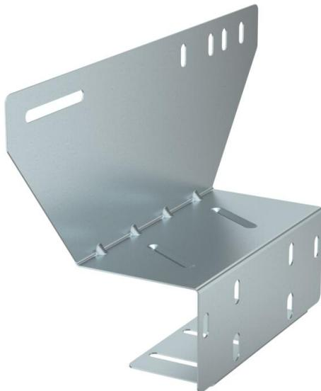
Placa de montaje universal para la fijación de FireBox serie T en la parte delantera de bandejas portacables y bandejas de rejilla, y escaleras de cable con ala máx. de 60 mm. Permite el montaje seguro de los cables de mantenimiento de función, sin que sea necesario doblarlos sobre la barra lateral. Apropiado para todas las FireBox.
