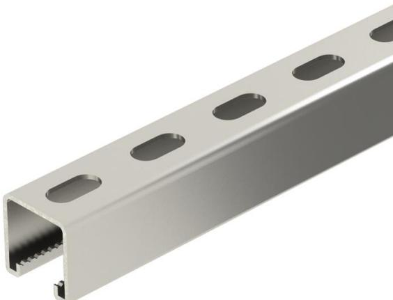
Perfiles C para cargas pesadas para la instalación individual de construcciones portantes para, p. ej., bandejas portacables o como consola para armarios eléctricos. También utilizable para el cableado, en combinación con abrazaderas sobre perfil con patillas tipo U.
