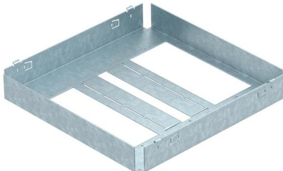
Soporte de montaje para tres tapas APMT5 que sirven para el montaje de mecanismos de instalación bajo marcos RFS en la caja bajo suelo UZD250-3.
