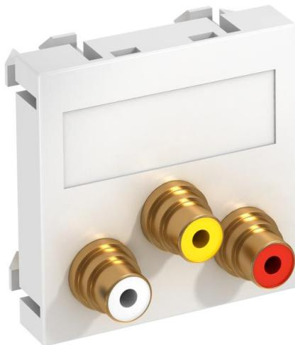
Soporte multimedia con tres conectores Cinch para audio-vídeo, salida recta de cable, con rótulo de identificación, tres hembrillas Cinch (RCA) con conexión para soldadura, código cromático amarillo/rojo/blanco. Placa de soporte con enganche, apropiada para el montaje vertical y horizontal en el entorno del sistema.
