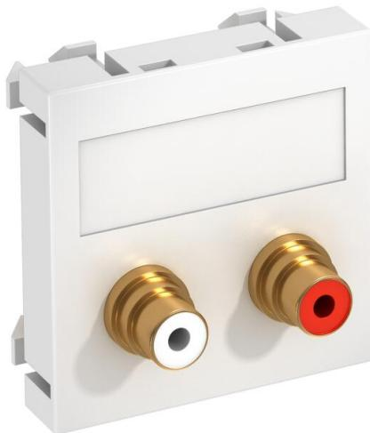
Soporte multimedia con dos conectores cinch para audio R/L, salida recta de cable, con campo identificativo, dos conectores cinch (RCA) en versión toma-toma, código cromático rojo/blanco. Placa de soporte con enganche, adecuada para el montaje vertical y horizontal en el entorno del sistema.
