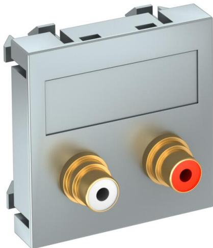
Soporte multimedia con dos conectores cCinch para audio R/L, salida recta de cable, con campo identificativo, dos conectores cinch (RCA) con conexión por soldadura, código cromático rojo/blanco. Placa de soporte con enganche, apropiada para el montaje vertical y horizontal en el entorno del sistema.
