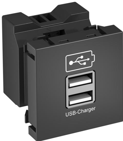
Cargador USB con dos conectores USB tipo A, para cargar 1-2 mecanismos móviles, corriente de carga máxima 1x 2100 mA o 2x 1050 mA.
