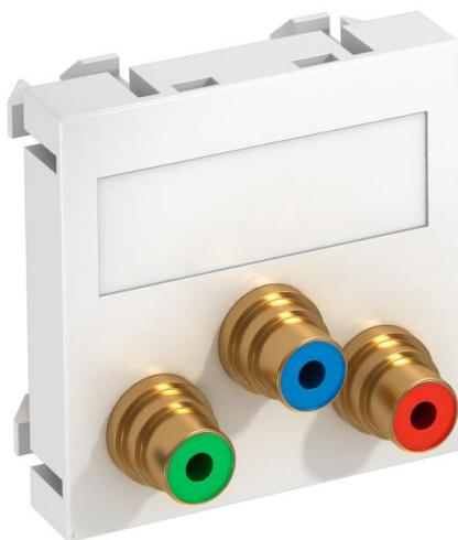
Soporte multimedia con tres conectores cinch para vídeo, salida recta de cable, con campo identificativo, tres conectores cinch (RCA) con conexión por soldadura, código cromático rojo/verde/azul. Placa de soporte con enganche, apropiada para el montaje vertical y horizontal en el entorno del sistema.
