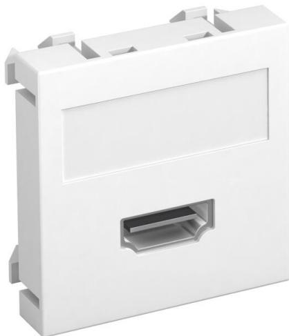
Soporte multimedia con un conector HDMI, salida recta de cable, con campo identificativo, conector HDMI con conexión por tornillo. Placa de soporte con enganche, adecuada para el montaje vertical y horizontal en el entorno del sistema.
