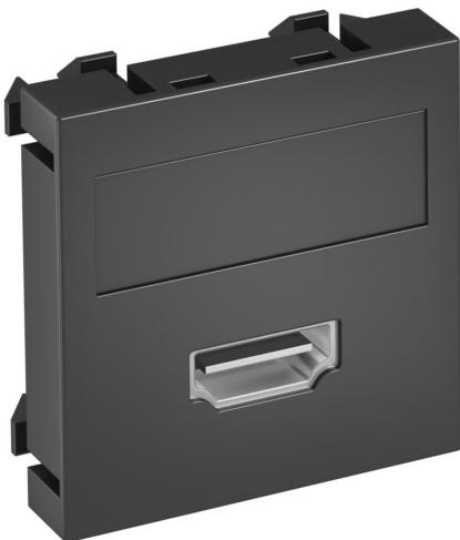
Soporte multimedia con un conector HDMI, salida recta de cable, con campo identificativo, conector HDMI con conexión por tornillo. Placa de soporte con enganche, apropiada para el montaje vertical y horizontal en el entorno del sistema.
