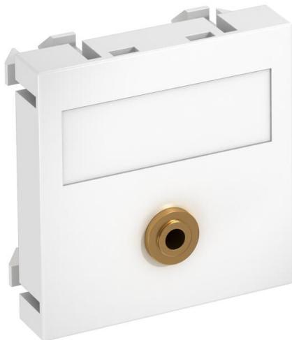
Soporte multimedia con un minijack, salida recta de cable, con campo identificativo, conector minijack (TRS 3,5 mm) con conexión por soldadura. Placa de soporte con enganche, adecuada para el montaje vertical y horizontal en el entorno del sistema.
