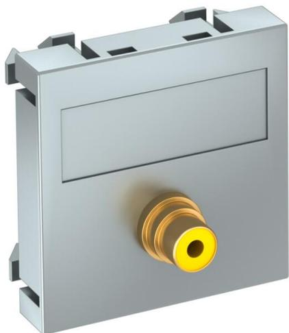
Soporte multimedia con un conector cinch para vídeo, salida recta de cable, con campo identificativo, conector cinch (RCA) en versión toma-toma, código cromático amarillo. Placa de soporte con enganche, adecuada para el montaje vertical y horizontal en el entorno del sistema.
