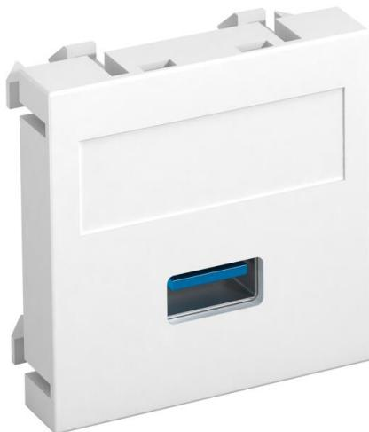
Soporte multimedia con un conector USB 3.0, salida recta de cable, con campo identificativo, conector USB 3.0 tipo A con conexión por tornillo. Placa de soporte con enganche, adecuada para el montaje vertical y horizontal en el entorno del sistema.
