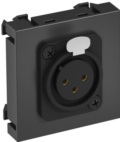
Soporte multimedia con un conector XLR, salida recta de cable, sin campo identificativo, conector XLR de 3 polos con conexión por tornillo. Placa de soporte con enganche, adecuada para el montaje vertical y horizontal en el entorno del sistema.
