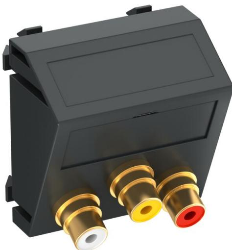
Soporte multimedia con tres conectores cinch para audio-vídeo, salida transversal de cable, con campo identificativo, tres conectores cinch (RCA) con conexión por soldadura, código cromático amarillo/rojo/blanco. Placa de soporte con enganche, apropiada para el montaje vertical y horizontal en el entorno del sistema.
