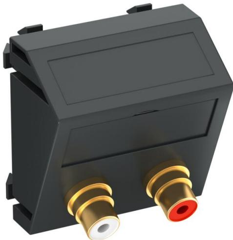
Soporte multimedia con dos conectores cinch para audio R/L, salida transversal de cable, con campo identificativo, dos conectores cinch (RCA) en versión toma-toma, código cromático rojo/blanco. Placa de soporte con enganche, adecuada para el montaje vertical y horizontal en el entorno del sistema.
