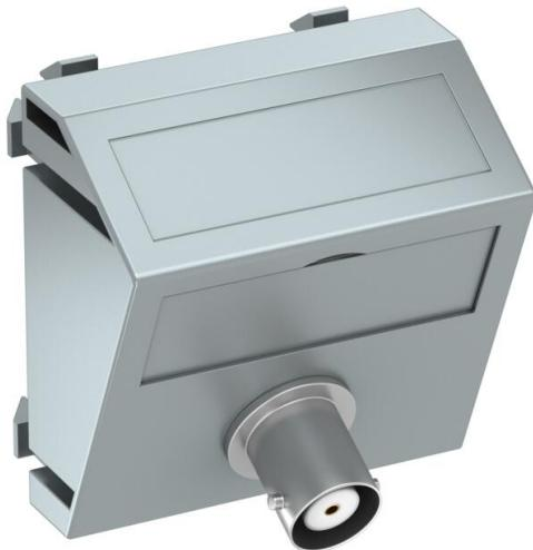
Soporte multimedia con un conector BNC, salida transversal de cable, con campo identificativo, acoplamiento BNC en versión toma-toma. Placa de soporte con enganche, apropiada para el montaje vertical y horizontal en el entorno del sistema.
