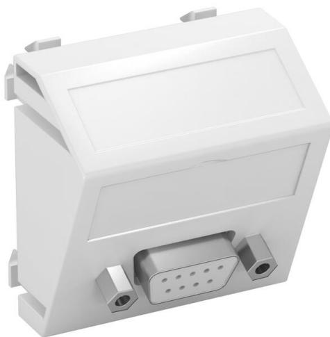
Soporte multimedia con un conector D-Sub9, salida transversal de cable, con campo identificativo, conector D-Sub9 (RS232) con conexión por tornillo. Placa de soporte con enganche, adecuada para el montaje vertical y horizontal en el entorno del sistema.
