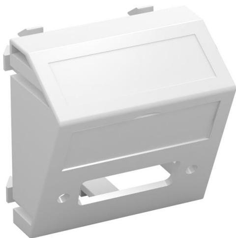
Soporte multimedia para un conector DVI, salida transversal de cable, con campo identificativo, sin conector. Placa de soporte con enganche, adecuada para el montaje vertical y horizontal en el entorno del sistema.
