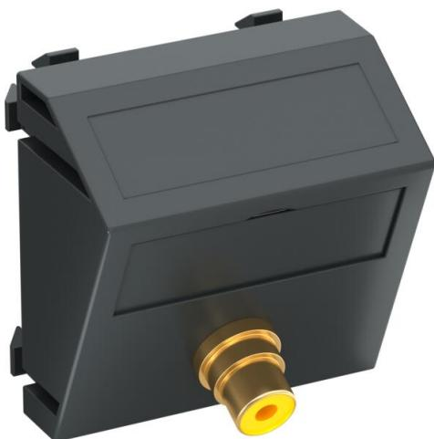
Soporte multimedia con un conector cinch para vídeo, salida transversal de cable, con campo identificativo, conector cinch (RCA) en versión toma-toma, código cromático amarillo. Placa de soporte con enganche, adecuada para el montaje vertical y horizontal en el entorno del sistema.
