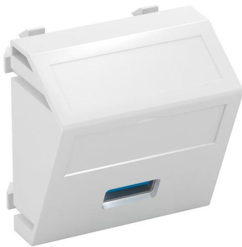
Soporte multimedia con un conector USB 3.0, salida transversal de cable, con campo identificativo, conector USB 3.0 tipo A con conexión por tornillo. Placa de soporte con enganche, adecuada para el montaje vertical y horizontal en el entorno del sistema.
