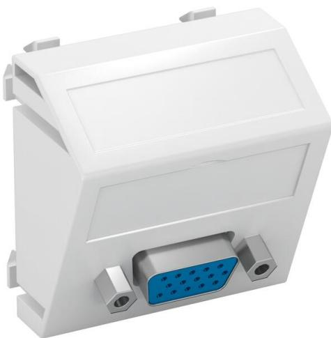
Soporte multimedia con un conector VGA, salida transversal de cable, con campo identificativo, conector VGA (HD 15) con conexión por tornillo. Placa de soporte con enganche, adecuada para el montaje vertical y horizontal en el entorno del sistema.
