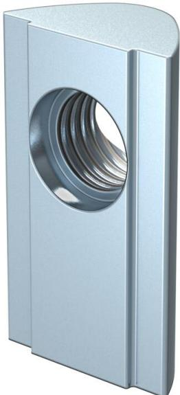
Tuerca de ranura para rosca M8 para montaje de piezas y accesorios en perfil de columna de distribución eléctrica industrial ISS. Una pieza a presión en la parte inferior permite que la tuerca oscile en la ranura sin caerse. Seguro automático contra giro mediante perfil en la parte superior.
