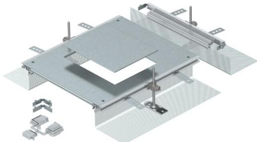
Ampliación de canal lista, para montar una unidad portamecanismos de tamaño 6. Está compuesta por perfiles laterales con pared lateral flexible de tela metálica, perfiles de apoyo en el pavimento, una tapa de canal con abertura de montaje cerrada de forma ciega y un final de canal. Se suministra con 3 ángulos de fijación de altura regulable, 3 piezas de anclaje 1 junta de soporte de tapa (la unidad de nivelación para la junta no está incluida) y 1 juego de piezas para derivación angular.
