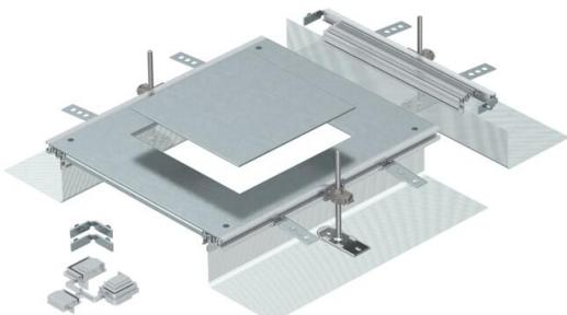
Ampliación de canal lista, para montar un conjunto portamecanismos de tamaño 9. Está compuesta por perfiles laterales con pared lateral flexible de tela metálica, perfiles de apoyo en el pavimento, una tapa de canal con abertura de montaje cerrada de forma ciega y un final de canal. Se suministra con 3 ángulos de fijación de altura regulable, 3 piezas de anclaje 1 junta de soporte de tapa (la unidad de nivelación para la junta no está incluida) y 1 juego de piezas para derivación angular.
