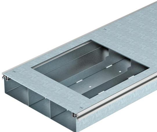
Unidad de canal de 3 compartimentos a ras de pavimento con 3 tapas de montaje para GES9 para la conducción de cables. Se suministra con conectores para canal, 6 ángulos de fijación y tabiques separadores. La tapa del canal se suministra atornillada.
