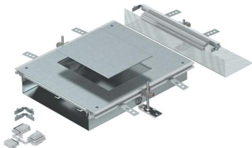
Ampliación de canal lista, para montar una unidad portamecanismos de tamaño 6. Está compuesta por una base de canal (con perfiles laterales y de apoyo en el pavimento), una tapa de canal con abertura de montaje cerrada de forma ciega y un final de canal. Se suministra con 3 ángulos de fijación de altura regulable, 3 piezas de anclaje y una pieza angular.
