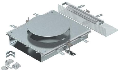
Ampliación de canal lista, para montar una unidad portamecanismos de tamaño R9. Está compuesta por una base de canal (con perfiles laterales y de apoyo en el pavimento), una tapa de canal con abertura de montaje cerrada de forma ciega y un final de canal. Se suministra con 3 ángulos de fijación de altura regulable, 3 piezas de anclaje y una pieza angular.
