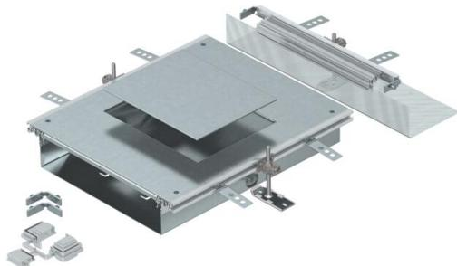
Ampliación de canal lista, para montar una unidad portamecanismos de tamaño 6. Está compuesta por una base de canal (con perfiles laterales y de apoyo en el pavimento), una tapa de canal con abertura de montaje cerrada de forma ciega y un final de canal. Se suministra con 3 ángulos de fijación de altura regulable, 3 piezas de anclaje y una pieza angular. Tamaño de la abertura de montaje apropiado para montar una unidad de montaje rectangular de tamaño nominal 6.
