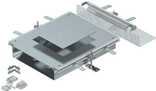
Ampliación de canal lista, para montar un conjunto portamecanismos de tamaño 9. Está compuesta por una base de canal (con perfiles laterales y de apoyo en el pavimento), una tapa de canal con abertura de montaje cerrada de forma ciega y un final de canal. Se suministra con 3 ángulos de fijación de altura regulable, 3 piezas de anclaje y una pieza angular. Tamaño de la abertura de montaje apropiado para montar una unidad de montaje cuadrada de tamaño nominal 9 o 9/55.
