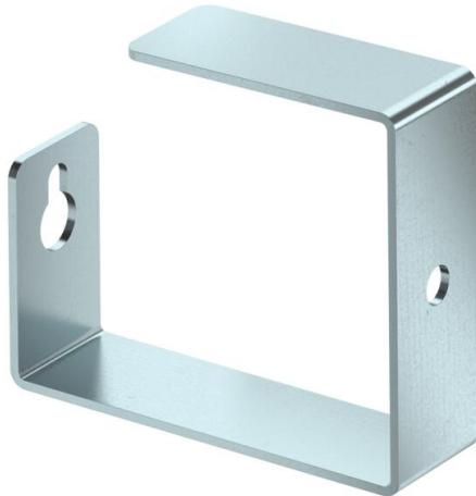
Soporte de separación como ayuda de instalación en caso de montaje en el techo del canal de protección contra el fuego PYROLINE® Con D, tipo PLCD D061220 y tipo PLCD D091220. Montaje del soporte directamente en los tacos de fijación del canal de protección contra el fuego.
