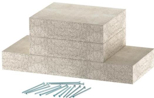
Cuello de corriente para pared para canal de protección contra el fuego PYROLI-NE® Con D EI60, tipo PLCD D060810 compuesto por hormigón ligero con fibra de vidrio, resistente al agua y a las heladas para el montaje en el canal de protección contra el fuego en el área de las conexiones de pared y techo o los tendidos de pared y techo. Compuesto de 3 placas individuales (anchura 100 mm, grosor 30 mm). Incluidos tornillos de cabeza avellanada. Incluidos tornillos de cabeza avellanada.
