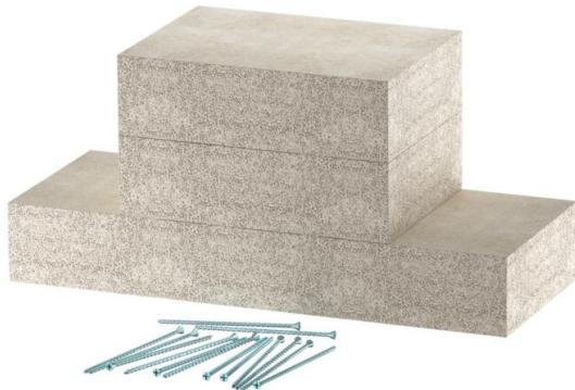
Cuello de corriente para pared para canal de protección contra el fuego PYROLI-NE® Con D EI90, tipo PLCD D090810 compuesto por hormigón ligero con fibra de vidrio, resistente al agua y a las heladas para el montaje en el canal de protección contra el fuego en el área de las conexiones de pared y techo o los tendidos de pared y techo. Compuesto de 3 placas individuales (anchura 100 mm, grosor 40 mm). Incluidos tornillos de cabeza avellanada. Incluidos tornillos de cabeza avellanada.
