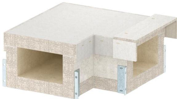
Curva de 90° para canal de protección contra el fuego PYROLINE® Con S EI90, tipo PLCS D091220 compuesto por hormigón ligero con fibra de vidrio, resistente al agua y a las heladas para la realización de cambios de sentido a lo largo del canal. Los conectores montados aseguran un montaje rápido in situ, mientras que las cubiertas colocadas sin apretar garantizan una inspección y reasignación rápidas.
