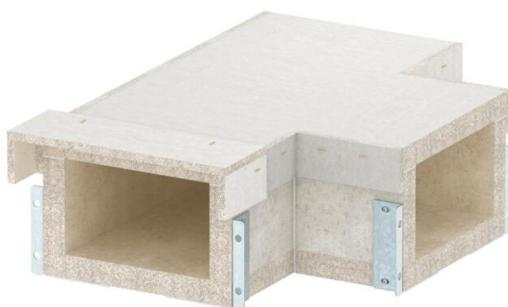
Pieza en T para canal de protección contra el fuego PYROLINE® Con S EI60, tipo PLCS D061220 compuesto por hormigón ligero con fibra de vidrio, resistente al agua y a las heladas para la realización de derivaciones en T a lo largo del canal. Los conectores montados aseguran un montaje rápido in situ, mientras que las cubiertas colocadas sin apretar garantizan una inspección y reasignación rápidas.
