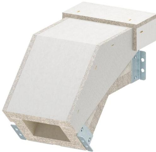
Curva vertical descendente para canal de protección contra el fuego PYROLI-NE® Con S EI60, tipo PLCS D060810 compuesto por hormigón ligero con fibra de vidrio, resistente al agua y a las heladas para la realización de cambios de sentido verticales (45°) a lo largo del canal. Los conectores montados aseguran un montaje rápido in situ, mientras que las cubiertas colocadas sin apretar garantizan una inspección y reasignación rápidas.
