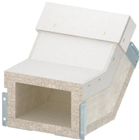
Curva vertical ascendente para canal de protección contra el fuego PYROLINE®. Con S EI60, tipo PLCS D061220 compuesto por hormigón ligero con fibra de vidrio, resistente al agua y a las heladas para la realización de cambios de sentido verticales (45°) a lo largo del canal. Los conectores montados aseguran un montaje rápido in situ, mientras que las cubiertas colocadas sin apretar garantizan una inspección y reasignación rápidas.
