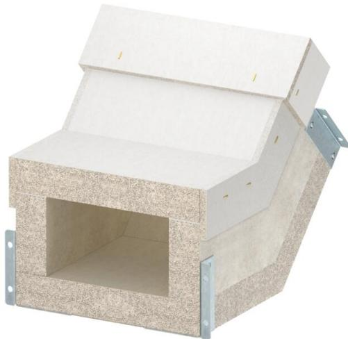
Curva vertical ascendente para canal de protección contra el fuego PYROLINE® Con S EI90, tipo PLCS D091220 compuesto por hormigón ligero con fibra de vidrio, resistente al agua y a las heladas para la realización de cambios de sentido verticales (45°) a lo largo del canal. Los conectores montados aseguran un montaje rápido in situ, mientras que las cubiertas colocadas sin apretar garantizan una inspección y reasignación rápidas.
